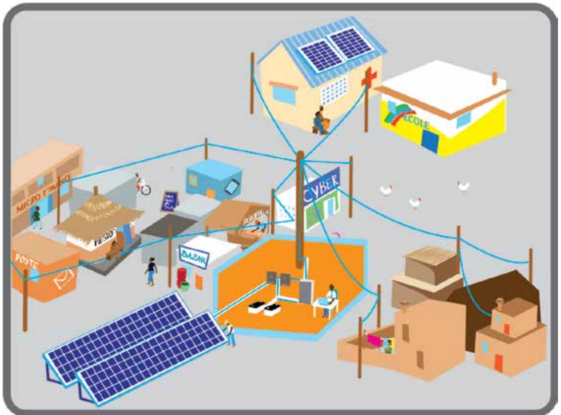
Zoom sur le miniréseau solaire.
